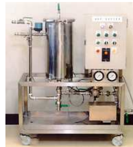
油水分離機装置の一例
