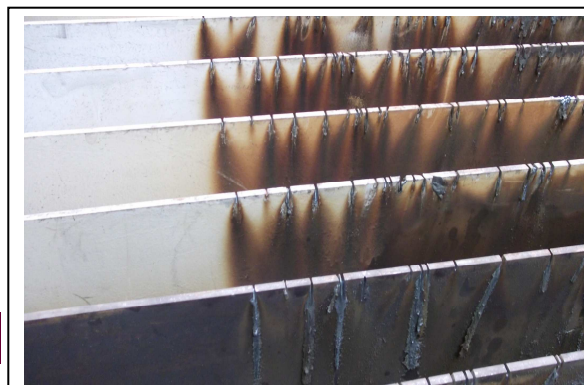
(上部:ドロスガード塗布部 下部:無塗布部)
