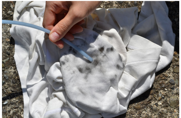
チューブ端部より出た汚れ(黒色部分)
