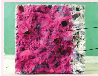
コンクリートの中性化診断結果の一例
